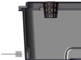
Praticare il foro di prelievo dell'acqua più in basso possibile vicino al fondo della vasca utilizzando la punta in dotazione (punta diametro 30 mm), al fine di garantire il pescaggio dell'acqua sul fondo del serbatoio.
