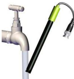
**5.** Lava la sonda pH sotto acqua corrente e asciuga la parte esterna con un panno pulito.
