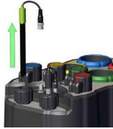
**2.** Estrai la vecchia sonda pH allentando il pressasonda.
