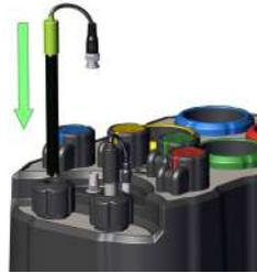
**3.** Inserire la nuova sonda pH fino a battuta e serrare il pressasonda.
