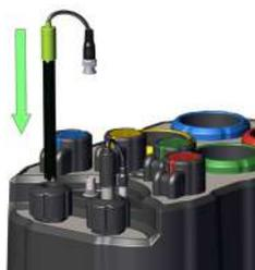
**6.** Inserisci la sonda pH fino a battuta e serrare il pressasonda.
