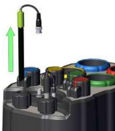
**2.** Estrai la sonda pH allentando il pressasonda.
