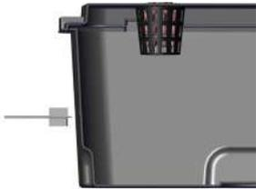
Praticare il foro di immissione dell'acqua in un punto superiore al livello massimo dell'acqua.
