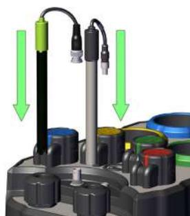
**3.** Inserire nei pressasonda le sonde pH ed EC fino ad arrivare a battuta. Avvitare i pressasonda con leggera forza e collegare i relativi connettori.
