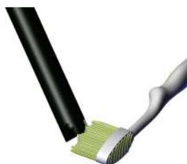
**4.** Pulire la sonda pH con lo spazzolino in dotazione evitando di toccare il bulbo di vetro con le dita.
