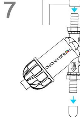
Rimuovere l'altro cappuccio terminale e sciacquare accuratamente il dispositivo con acqua. (Va bene anche l'acqua di rubinetto)
