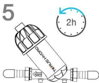
Lasciare l'unità in posizione con i tappi terminali fissati e la soluzione all'interno per 2 ore.
