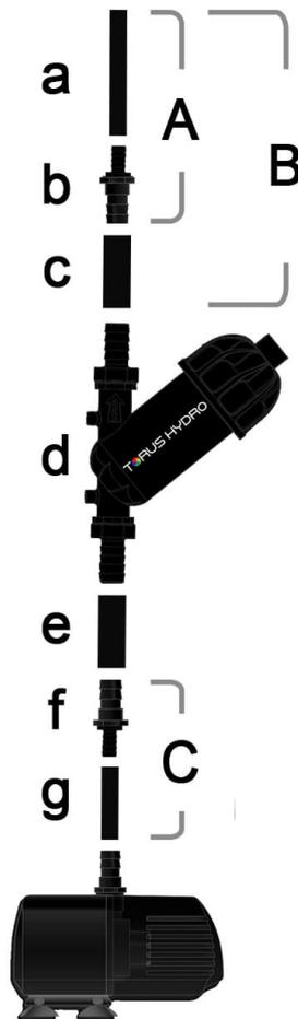
A - Richiesto solo quando è necessario un adattamento delle dimensioni del tubo.
